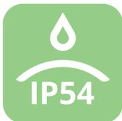
Степень IP54 обеспечивает защиту от попадания пыли и брызг воды внутрь изделия, поэтому розетки и выключатели этой серии можно устанавливать на улице.
